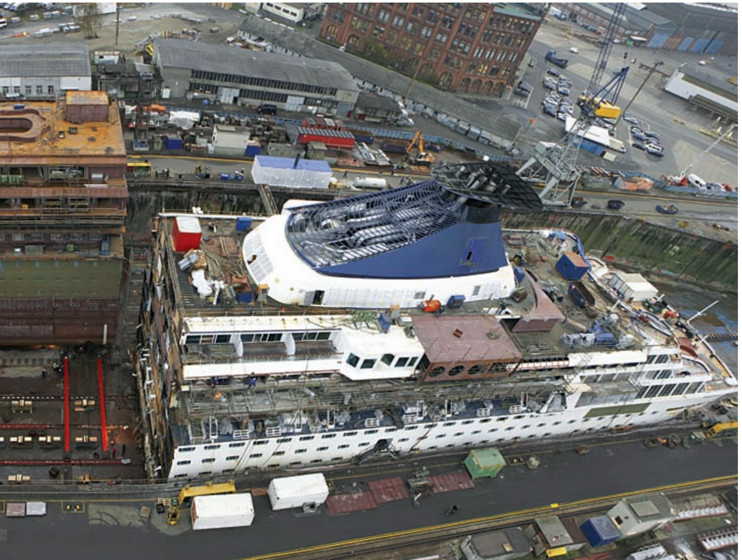
Die zweigeteilte »Norwegian Crown« erhält im Trockendock »Elbe 17« ihr 30,20 Meter langes Mittelsegment. Nach dem Umbau heißt das Schiff »Balmoral« und bietet Platz für 329 zusätzliche Passagiere.
